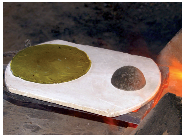
Abb. 8: Glasfladen und vorgeheizte Form vor dem Auflegen des Glasfladens (Foto: M. Arz).
