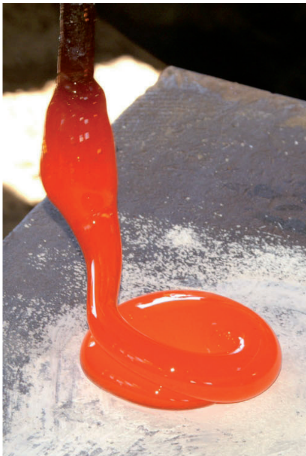
Abb. 1: Abfließen der zähflüssigen Glasmasse auf eine mit Trennmittel bestreute Unterlage (Foto: M. Arz).
