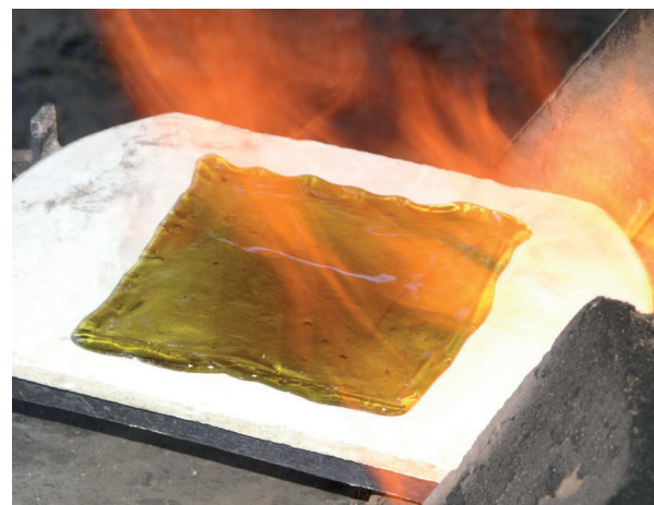
Abb. 4: Nachheizen des Werkstücks im Glasofen (Foto: M. Arz).
