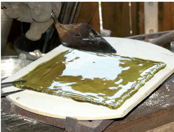
Abb. 5: Formkorrekturen am nunmehr annähernd quadratischen Werkstück. (Foto: M. Arz).
