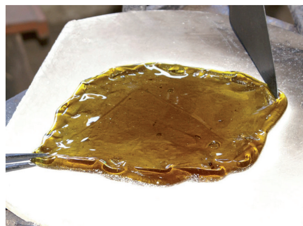
Abb. 3: Strecken des Glasfladens (Foto: M. Arz).
