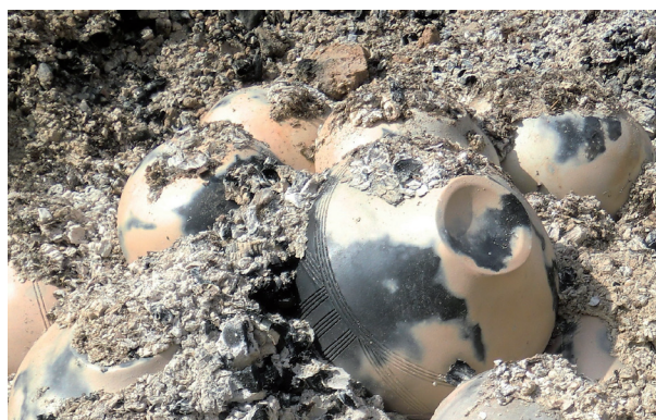
Abb. 15: Der offene Feldbrand. Keramik am Tag nach dem offenen Brand. Die Asche liegt lose auf und es sind einzelne schwarze Flecken auf den Scherben zu sehen (Foto: B. Kocak).
