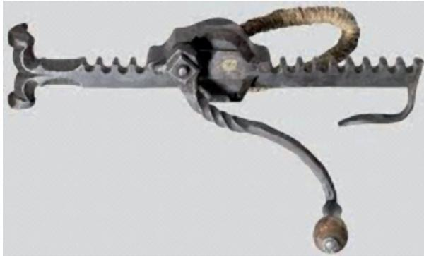
Abb. 12: Spätmittelalterliche Zahnwinde zum Spannen einer Armbrust (nach Lorenz / Zotz 2001, 48).
